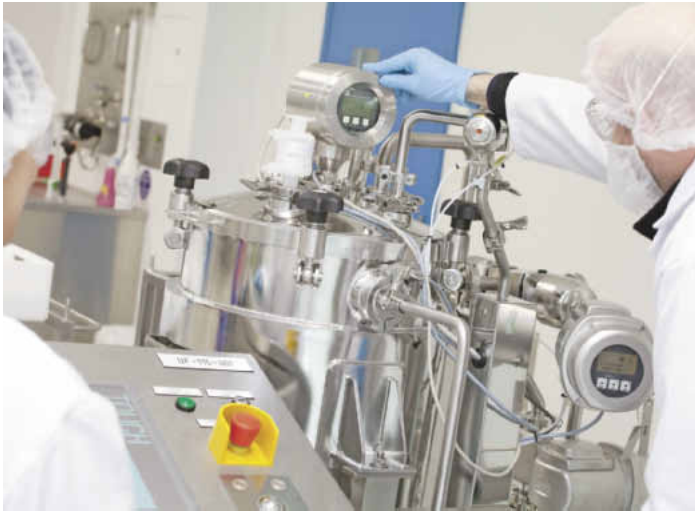
Bild 2: Geführte Radarmessung am Fermenter mit Levelflex erfüllt die Anforderungen der ASME BPE (links)
